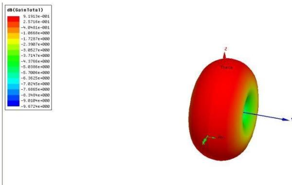
图6 Module 天线增益和3D方向图 (X轴为图4的左右方向, Y轴为图4的上下方向)
